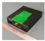
单边核磁共振传感器,测量区域位于传感器上方,可对大尺寸对象进行无损测量。可测量样品的横向、纵向弛豫时间,以及自扩散系数。
