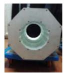
**2、Inside-out 及 Halbach 磁体** Inside-out 型 NMR 传感器可测量圆柱传感器外侧样品,用于钻孔式的 NMR 信号测量需求。
